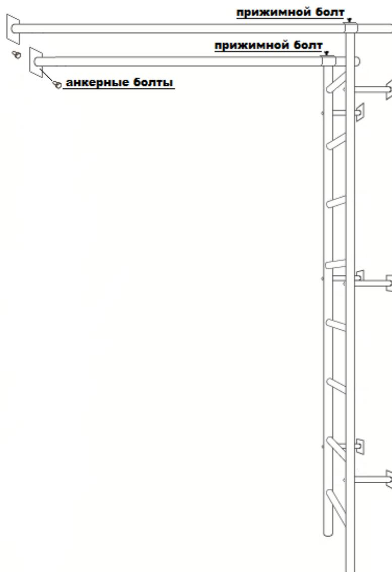
Закрепить лестницу к стене с помощью анкеров и дюбелей. Закрепить таким же способом верхнюю раму к стене. Завернуть прижимные болты верхней рамы в проушьях лестницы.
