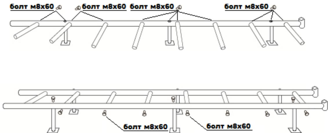
Вставить трубы верхней рамы в верхние проушья лестницы. Собранный конструкцию установить в коридоре.
