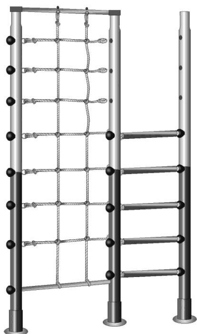
Рис.3 Сборка лестницы со стойкой
