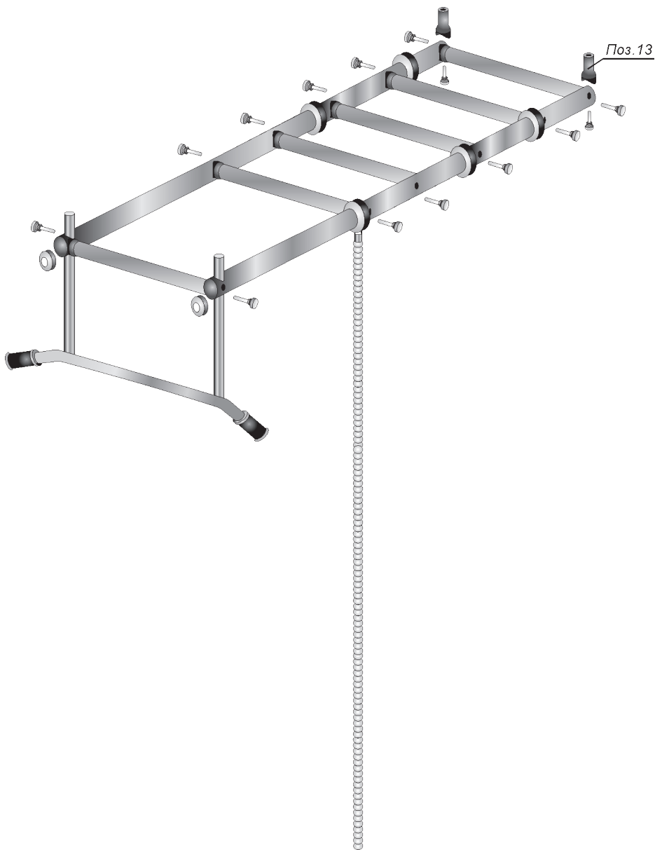
Рисунок 5. Схема сборки верхней рамы
