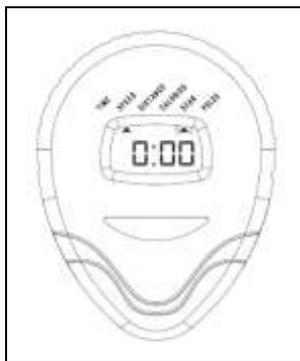
Компьютер начнёт работу автоматически, когда вы начнёте тренировку. Тем не менее, можно включить компьютер, нажав кнопку РЕЖИМ в нижней части компьютера.
